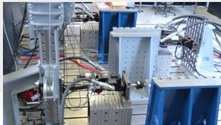
1-axiale Prüfung von FLCA
