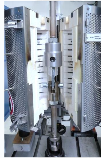
Warmzugversuch einer CFK-Aluminium-Verbindung
