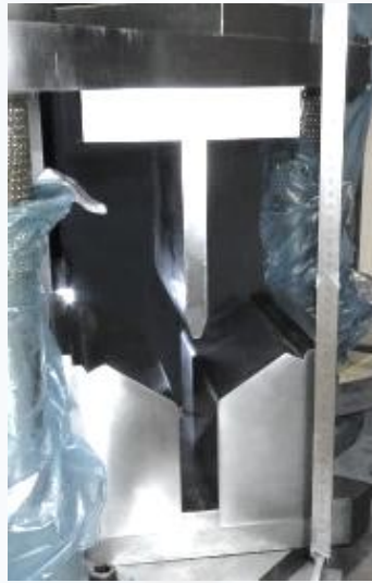
3-Punkt-Biegeprüfung asymmetrischer Profile
