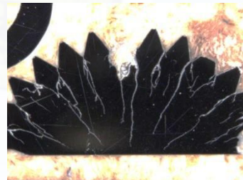
Schadensbegutachtung einer verzahnten Welle
