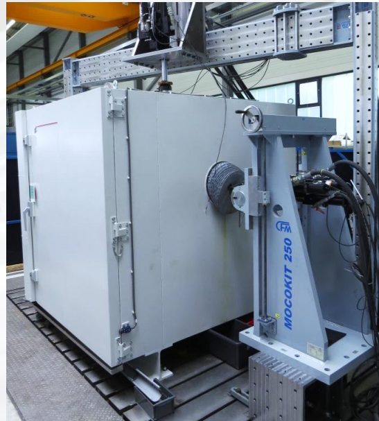
3- bzw. 4-axiale Prüfung von Blattfedern unter Klima
