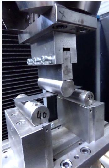
3-Punkt-Biegeprüfung von Punktschweißproben
