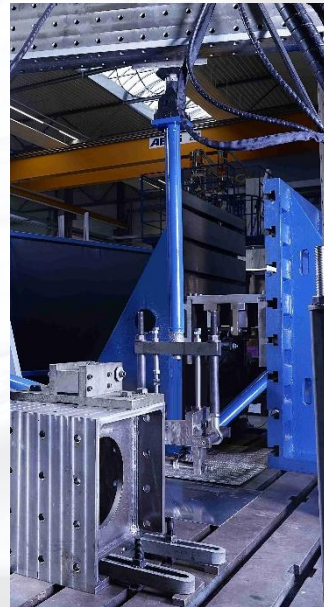
1-axiale Prüfung eines Chassis
