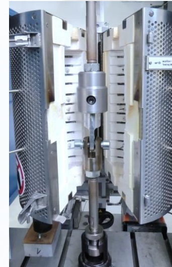
Warmzugversuch einer CFK-Aluminium- Verbindung
