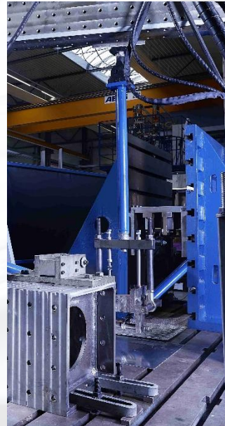
1-axiale Prüfung eines Chassis
