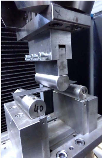
3-Punkt-Biegeprüfung von Punktschweiß- proben
