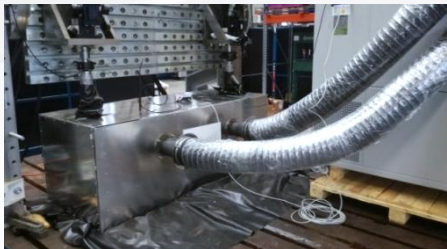
2-axiale Prüfung von Stabilisatoren unter Klima
