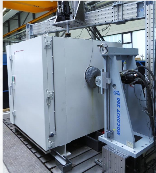
3- bzw. 4-axiale Prüfung von Blattfedern unter Klima
