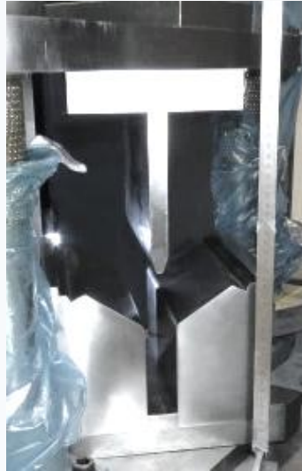
3-Punkt-Biegeprüfung asymmetrischer Profile
