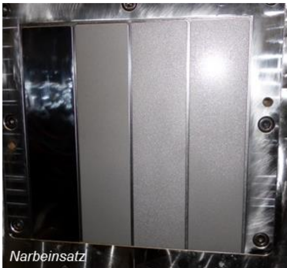
Narbeinsatz und Prüfkörper
