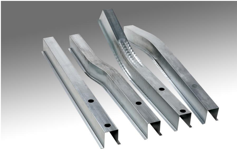
Profil im Ausgangszustand, mit S-Biegung und mit Biegung um die Profilquerachse
